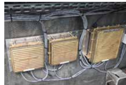
Die Aktuatoren im Heckbereich (li.) und die Schaltzentrale mit der CPU und den Verstärkern
